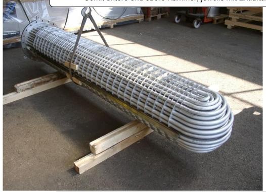
U-Rohr verfügt über das beste Einzelausdehnungsverhalten der Rohre, die so den geringsten Stress in die Rohrplatte erwirken. Somit ist diese Ausführung wartungsfrei.
