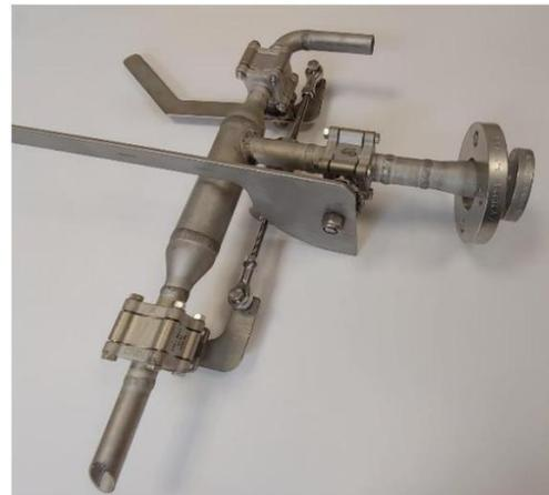
Cet échantillonneur est conçu pour un fonctionnement sécurisé, même pour le prélèvement d'échantillons dans des récipients sous pression. L'échantillon peut être prélevé sous vide ou dans des récipients sous pression jusqu'à 20 bars.
