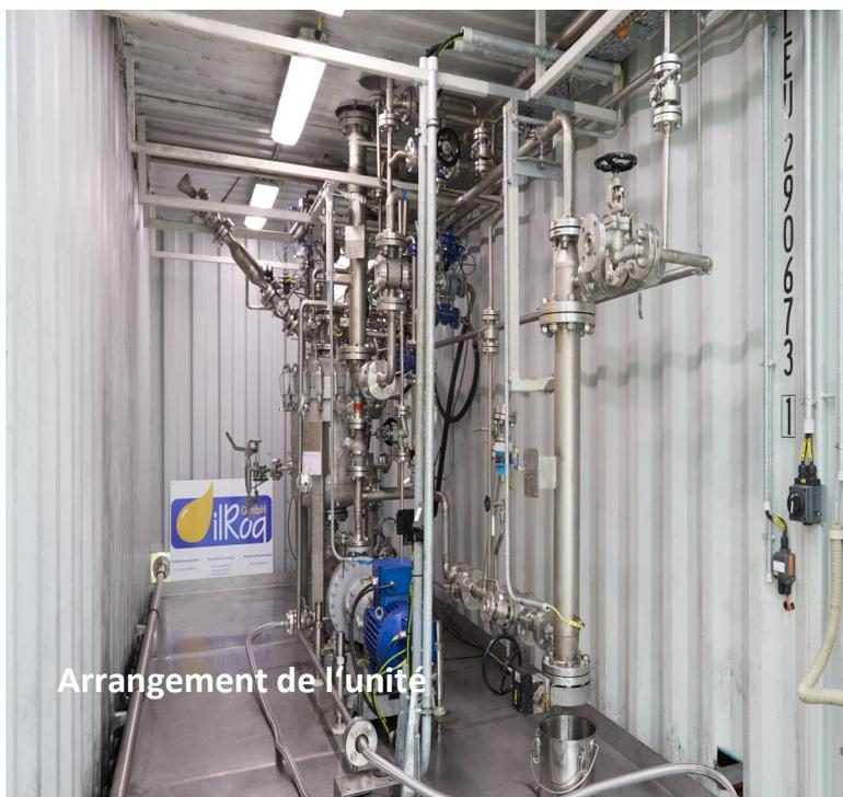
L'installation d'essai dispose d'un réacteur à boucle qui permet de réaliser différents types de procédés chimiques et oléo-chimiques tels que :
