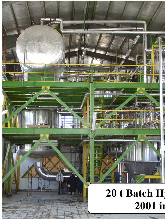
**20 t Batch Hydrieranlage
