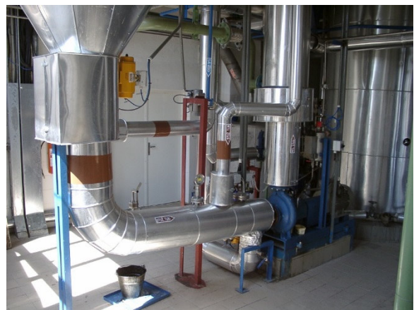
150 t/d Schlaufenreaktor – Umesterungsanlage in der Slowakischen Republik
