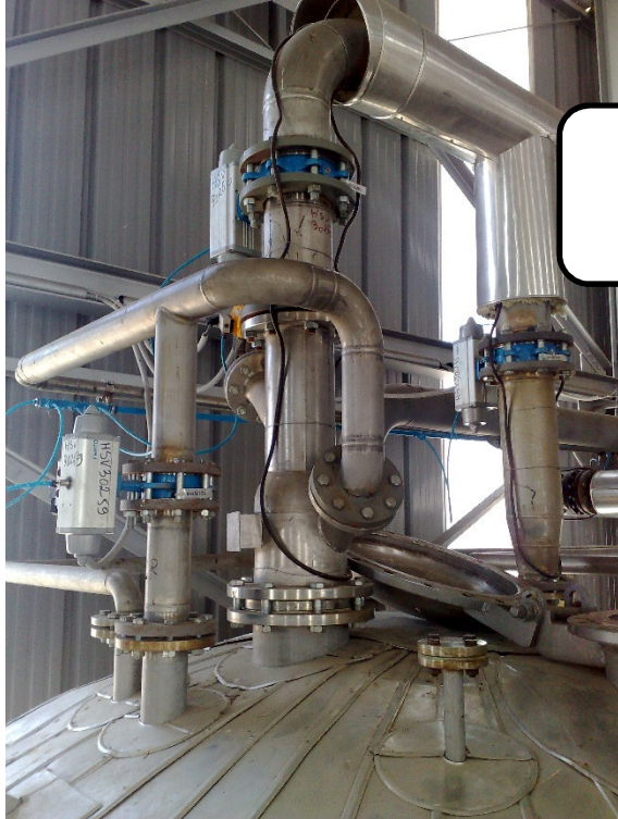
150 t/d Schlaufenreaktor – Umesterungsanlage in der Slowakischen Republik
