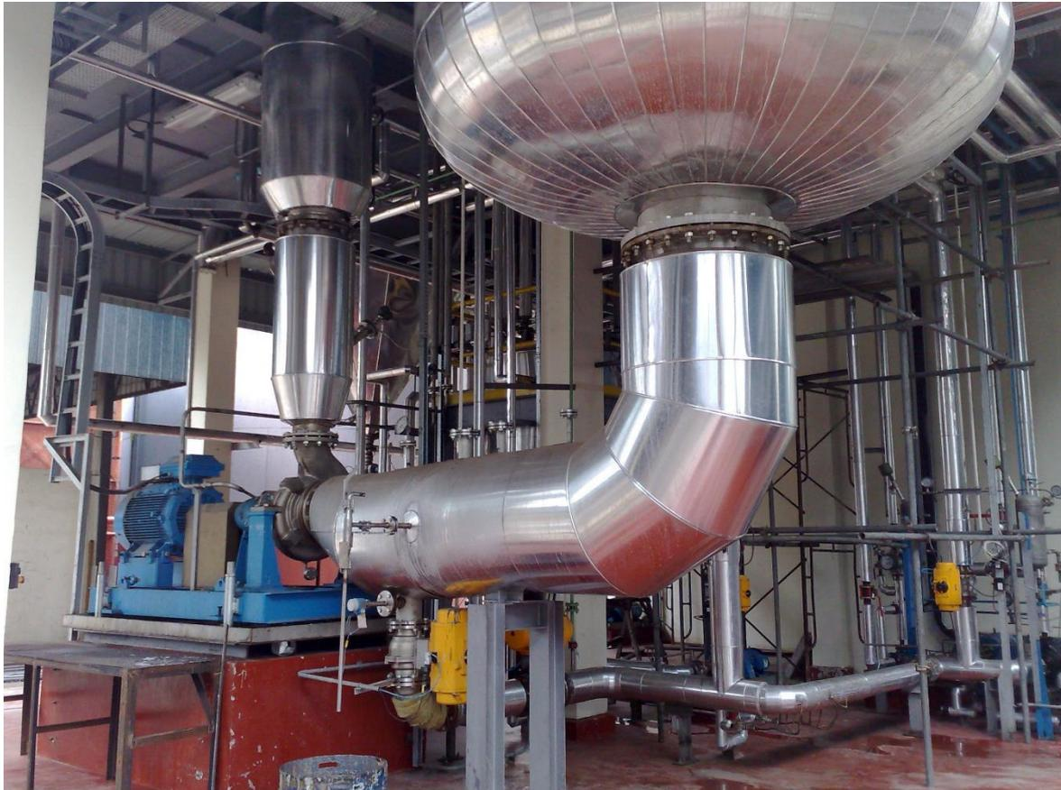
Für die Hydrierung von Ölen, Fetten und Fettsäuren bieten wir maßgeschneiderte technologische Lösungen an, sowohl Anlagen mit dem klassischen Rührwerksreaktor, als auch Anlagen mit dem modernen Schlaufenreaktor mit Anlagenleistungen von 50 – 400 t/d.
